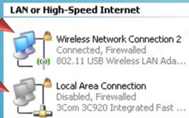
در شکل مشاهده می نماید که کارت شبکه کابلی به صورت Disable است و کارت شبکه وايرلس به صورت Enable می باشد.
